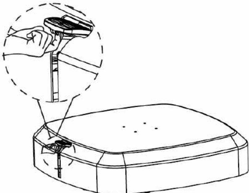
Durch Herunterdrücken des Fusspedals werden die Rollen abgesenkt und der Ständer wird angehoben.
