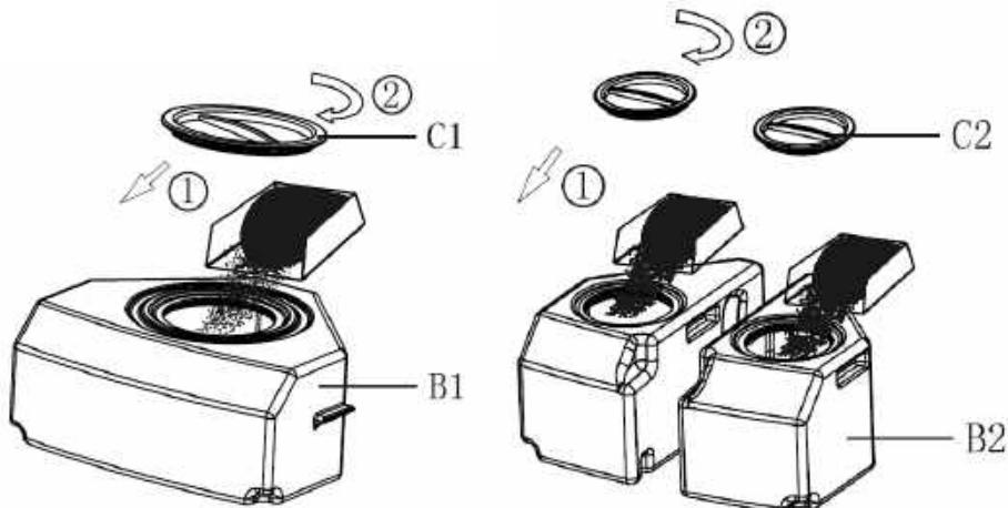
Die gefüllten Tanks mit den Schraubdeckeln verschließen.
